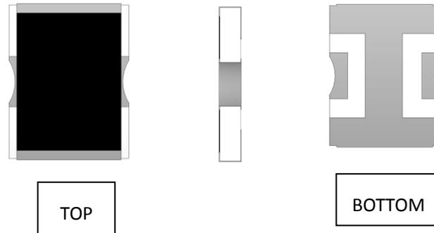
二、产品焊接完成后效果图如下，Bottom 面与 PCB 微带线进行接触焊接，黑色绝缘树脂必须是向上。
