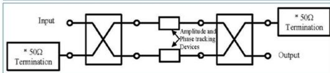
Yantel 定向耦合器功率检测、数据采样，实现功放系统自动增益补偿、监控等功能
