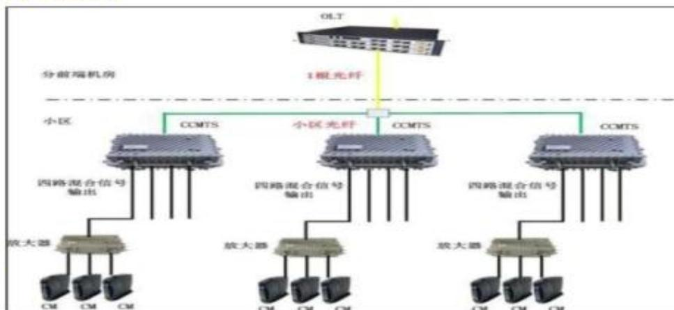
广电接入网各个 CCMTS 光节点设备与每路放大器之间需保持高低温增益平衡且每路一致, 设备前级每路都需增加温度补偿衰减器来反向补偿高低温增益需求。
